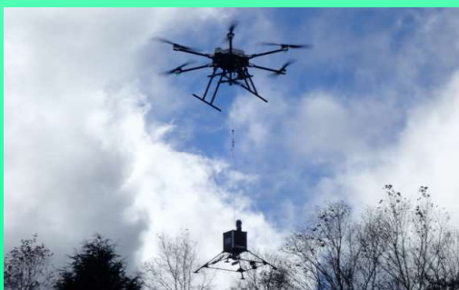
使用したUAVと降灰厚計測デバイス
