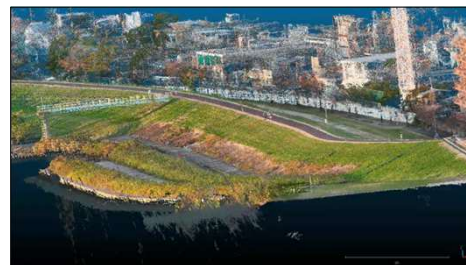
▲三次元点群データへの変換結果
