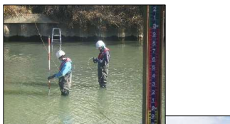
▲低水流量観測で流速を測定している様子（中川）
