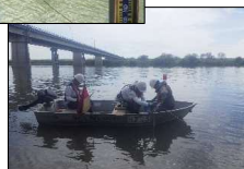
▲低水流量観測で水深を測定している様子（江戸川）
