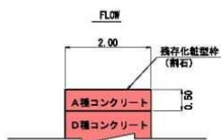
堤冠コンクリート側面詳細図 S=1:50
