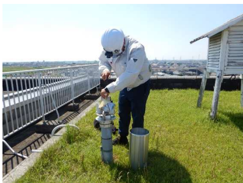
写真 5-3 雨量計点検状況
