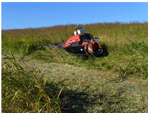
写真 8-4 7 割堤防における自律走行型草刈機の試行事例
