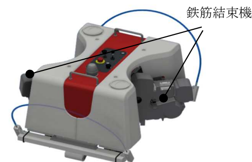
鉄筋結束ロボット
