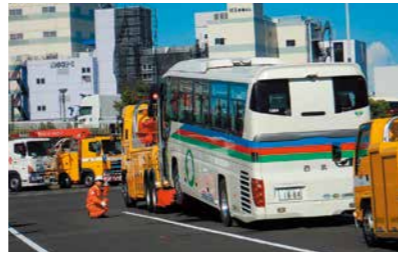
レッカー車による車両移動訓練(全日本レッカー協会)
