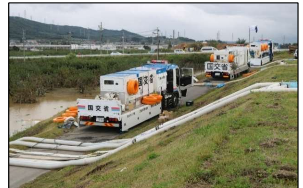
排水ポンプ車の配置状況
