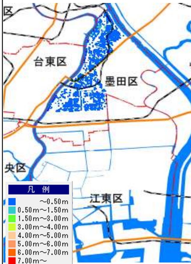
0.5m以下の浸水が残存する箇所
