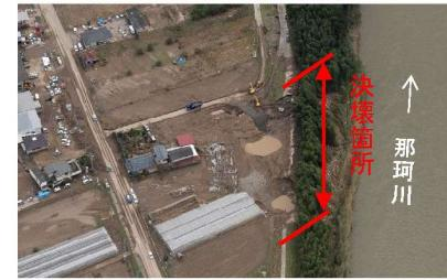
写真③堤防決壊状況（那珂川左岸40.0k
