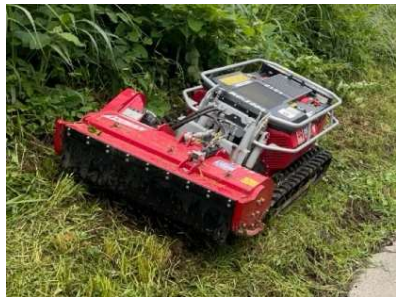
急傾斜地対応型の除草機を活用した除草の様子
