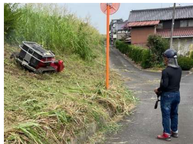
急傾斜地対応型の除草機を活用した除草の様子
