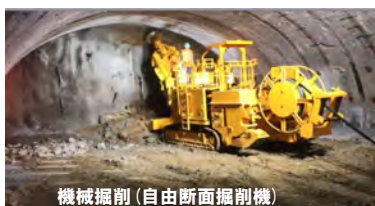
機械掘削（自由断面掘削機）
