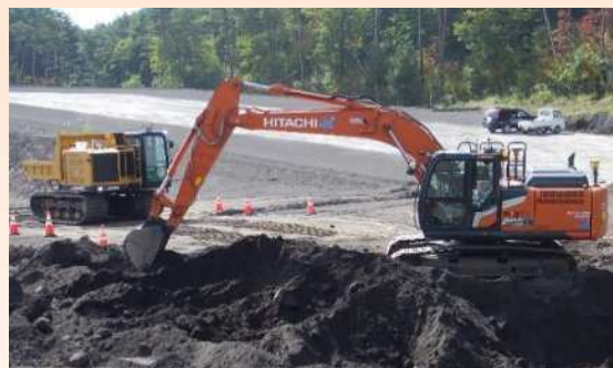
無人化施工機械 （ICTバックホウ、キャリアダンプ）
