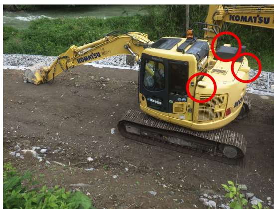
後方・側方監視モニタ付バックホウ
