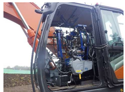
写真-3 遠隔操縦装置
