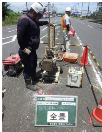
貫入試験による空洞調査
