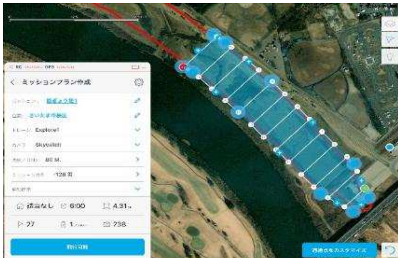
ドローンに飛行ルート設定し自動飛行で写真測量
