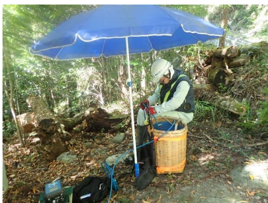
写真 6 孔内傾斜計観測状況
