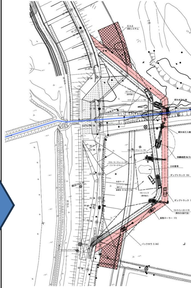
仮締切内タイロッド施工
