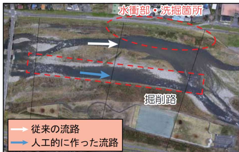
中州の筋掘り(掘削路)による侵食・洗掘対策
