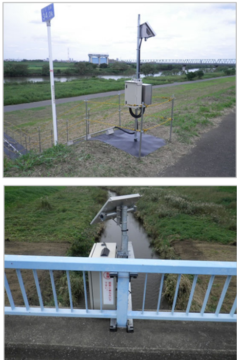
危機管理型水位計の写真 (上段:接触型、下段:非接触型)
