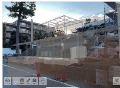
基礎・補強鉄骨モデル作成
