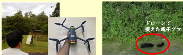
赤外線カメラを搭載したドローンによるクマの位置確認・追跡
