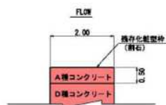
堤冠コンクリート側面詳細図 S=1:50
