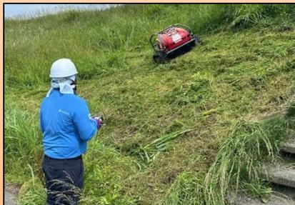
急傾斜地対応型除草機を用いた堤防除草
