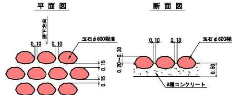
堤冠コンクリート側面詳細図 S=1:50
