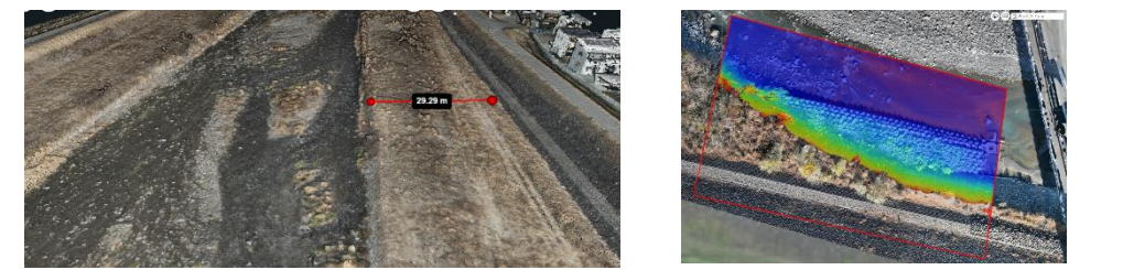
UAVで撮影した画像から河道の三次元データを作成
