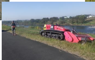
遠隔除草機による堤防除草
