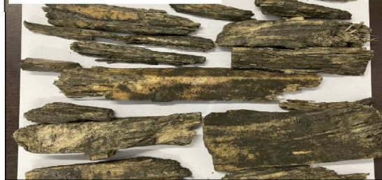
切削後に出てきたFFU切削片
