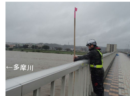
流量観測実施状況(石原地点)
