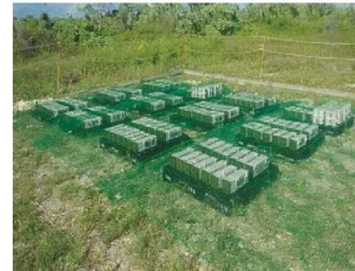
新素材のコンクリートの曝露試験)
