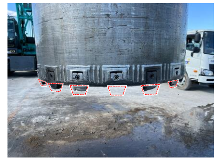
ケーシングビットの摩耗状況
