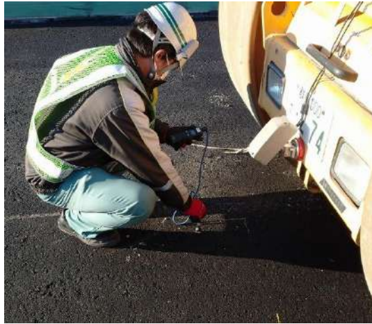
写真3 接触式温度計による路面温度との比較状況
