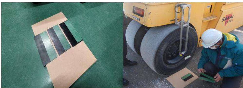
写真2 精度確認用の木板と鉄板(左)、精度確認の実施イメージ(右)
