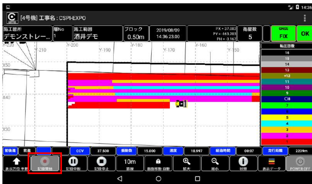
写真10 転圧回数管理（記録中）のメイン画面
