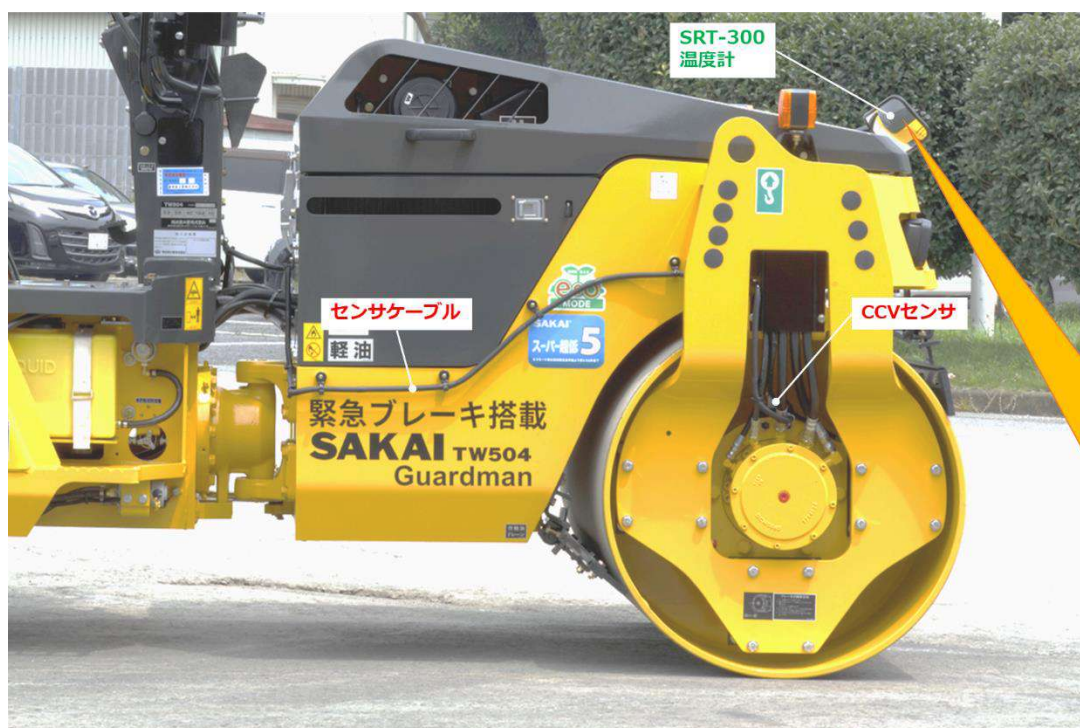
写真4 機器設置の例
