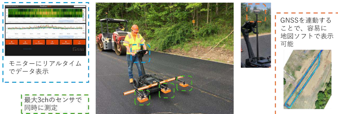
図2．移動式電磁波密度計のシステム構成図
