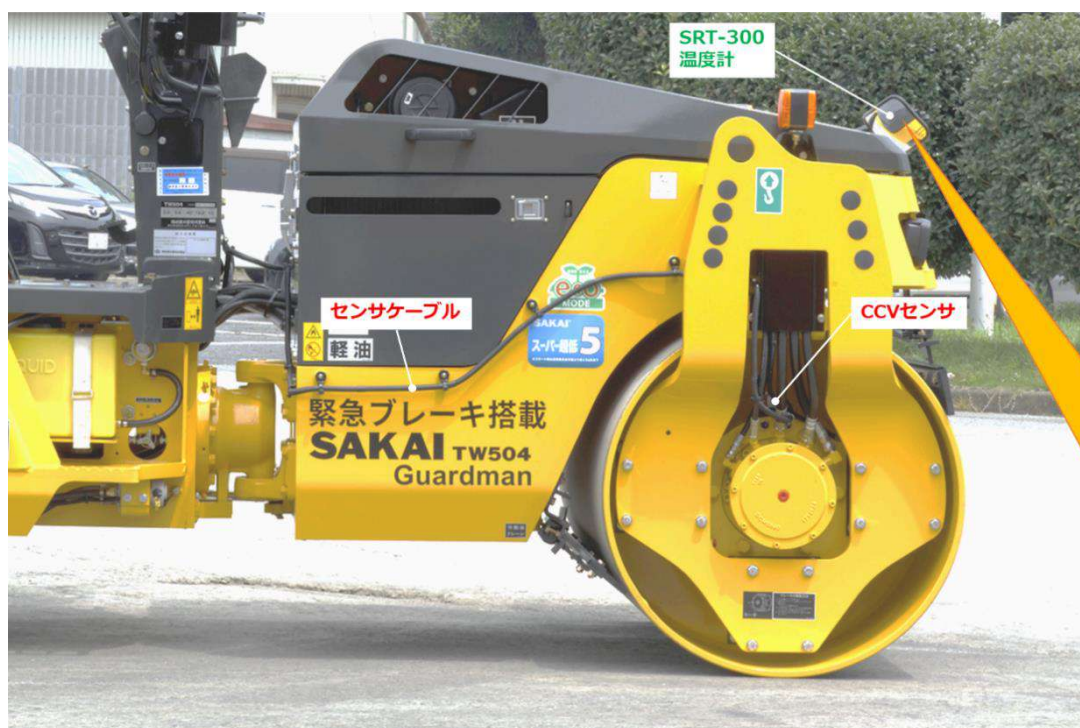
写真4 機器設置の例
