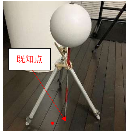
図 4.16 基準球設置状況例
