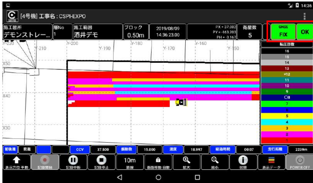
写真2 GNSS 精度の確認
