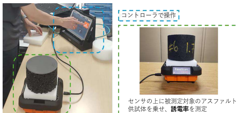
図3．PaveScan MDMのシステム構成図
