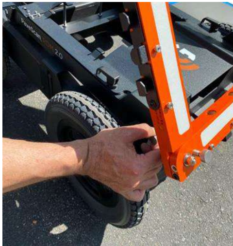
図 10. つまみによるセンサの傾け
