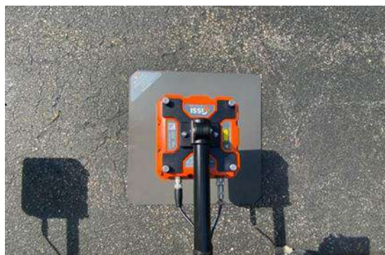
図 11. センサ真下への金属板の配置
