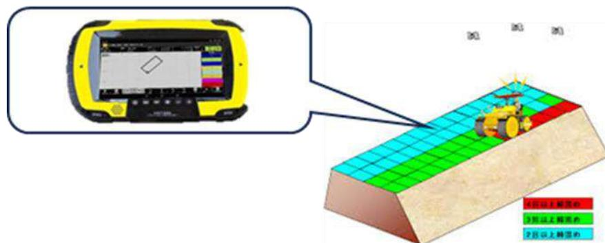
図 3.1 車載モニタによる締固め回数確認のイメージ
