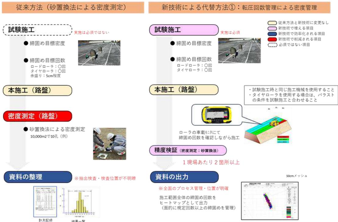
図 1.1 従来の管理方法と本管理要領での管理手法の流れ(路盤工)
