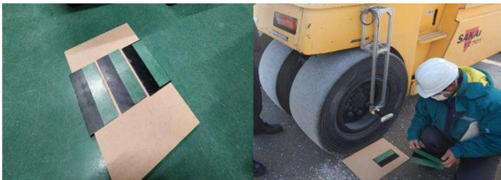
図 2.6 精度確認用の木板と鉄板(左)、精度確認の実施イメージ(右)
