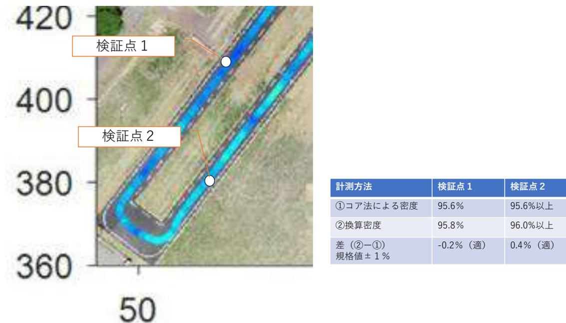
図 4.2 精度検証結果の報告 (例)
