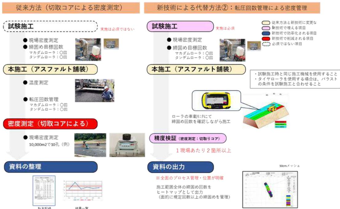
図 1.2 従来の管理方法と本管理要領での管理手法の流れ(アスファルト舗装工)
