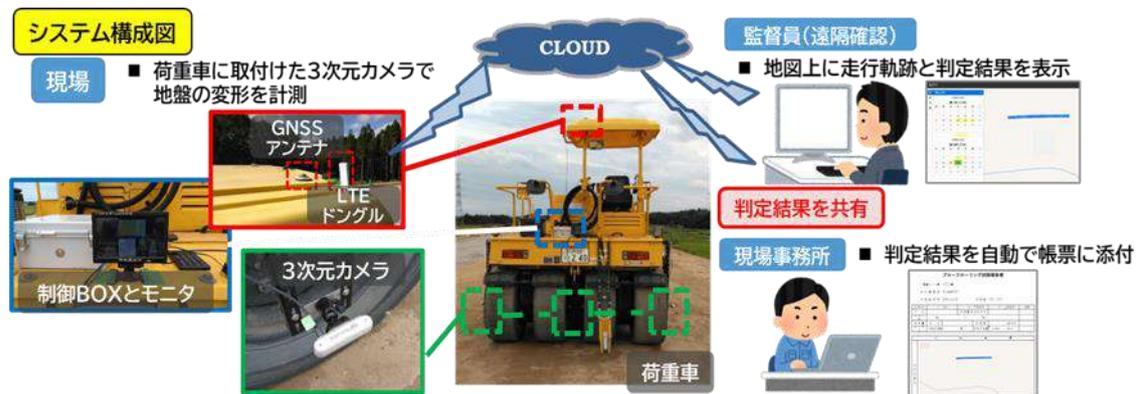
図 2.1 標準的なシステム構成
