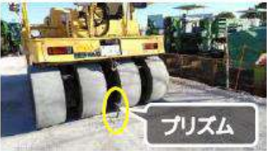
【写真3 自動追尾TSによる変形量の計測】
