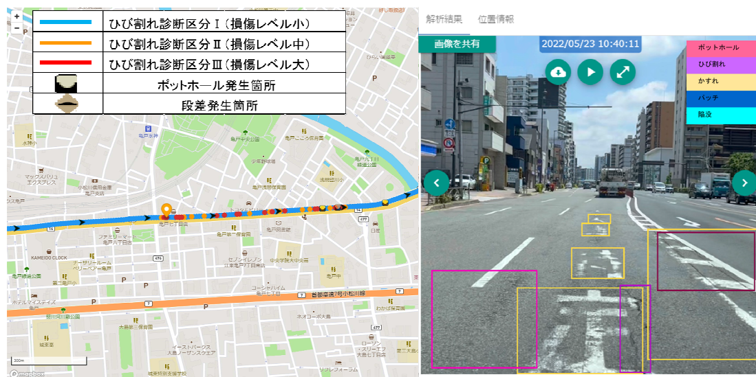
破損状況と評価から抽出した補修箇所のイメージ
