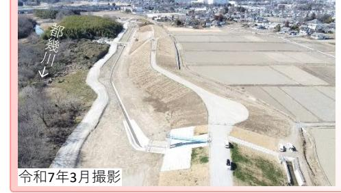
簡易型河川監視カメラ・越水センサー設置状況
