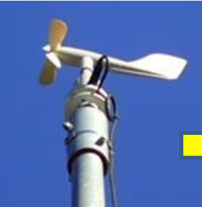
更新前の風向風速計 プロペラの回転で風速を観測
