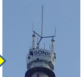
更新後の風向風速計 3本の超音波センサー間で 伝達時間の差から風を観測
