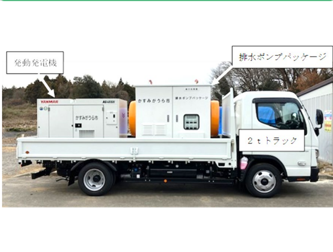
「移動式排水ポンプ車」
