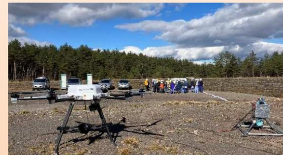
UAVと降灰厚計測デバイス
