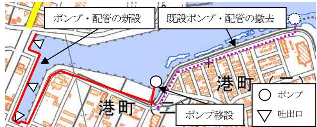
図-8 案2 既設配管の中間付近に新設
