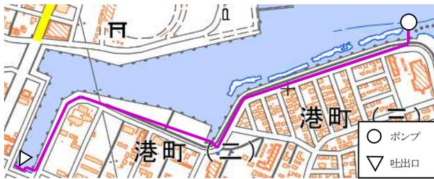
図-2 土浦港送水ポンプ 配管図
