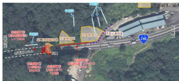
図-4 法面崩落箇所と応急復旧工法
