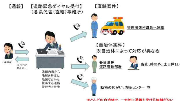
図-1 道路緊急ダイヤル（#9910）の運用フロー図
