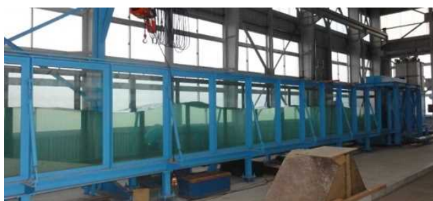
写真-1 長水路造波装置
