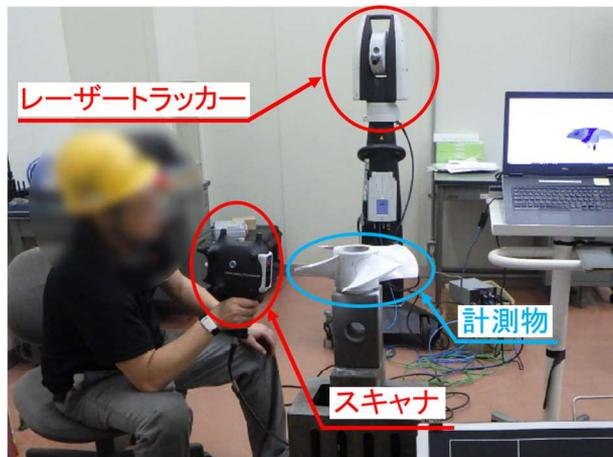
図-9 三次元測量による計測状況
