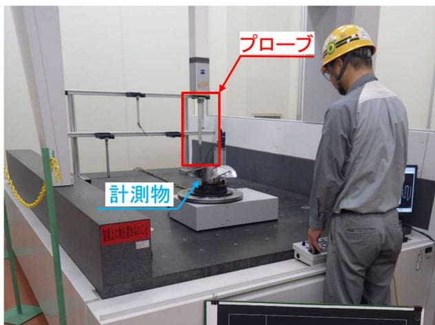
図-6 三次元測量を用いた計測状況
