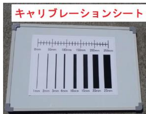
写真-6 キャリブレーションシートを用いたドローン撮影
