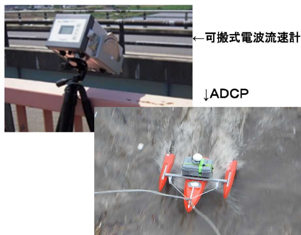
写真2 可搬式電波流速計及びADCPによる計測
