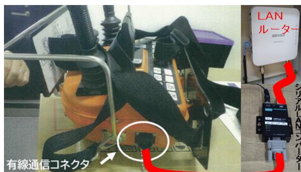
図-7 遠隔操作リモコンの変換
