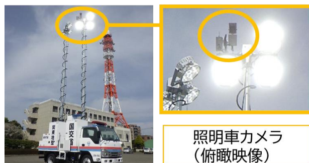
図-8 2柱式照明車（先端カメラ付き）
