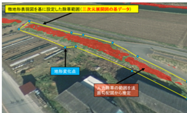
図-2 微地形表現図を基に設定した除草範囲（三次元展開図の基データ）
