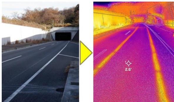
図5 試験運転時のヒーター温度上昇の状況
