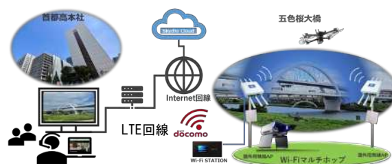
図-3 SkydioDock の機材構成（五色桜大橋）
