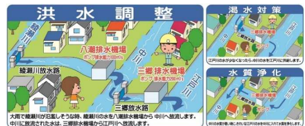
図-2 三郷排水機場の役割の概念図
