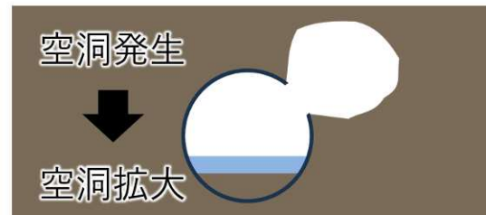
図-2 想定される路面下空洞発生のプロセス（イメージ）
