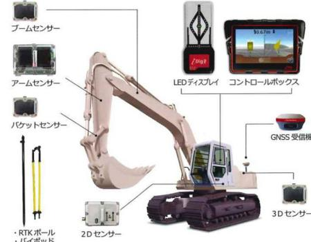
従来の小型ICT建設機械に後付で装着することでマシンガイダンス施工が可能となる。
