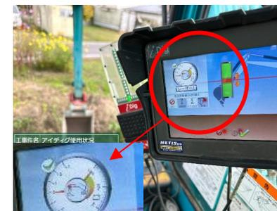
勾配機能付き回転レーザーと2DMGを併用し、下水道勾配を付けた平面レーザーを掘削場所に設置し2DMGで床掘りを行い、オペレーターがキャブから降りることなく深さの検測を実施
